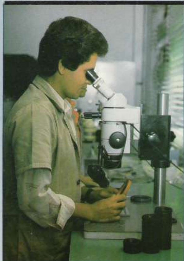
Controle de acabamento do Retentor.
