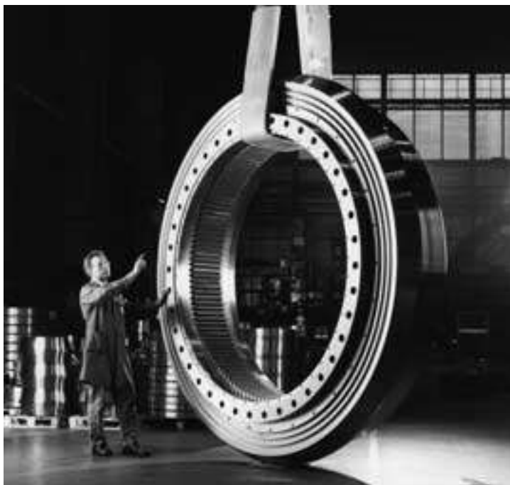
Rolamento axial-radial de rolos cilíndricos com coroa dentada integrada
