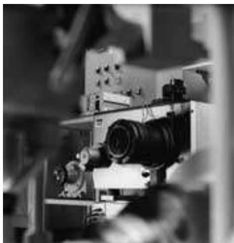
Bancada de ensaio para graxa FE8
